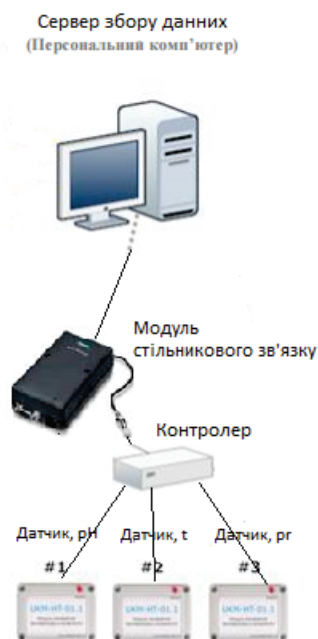
Рис. 1. Структура комп'ютерної системи контролю забруднення річки
